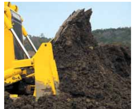
La hoja Sigmadozer® ofrece una mayor capacidad de rodado del material.
