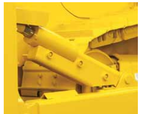
Las líneas hidráulicas se encuentran integradas en estructuras siempre que sea posible
