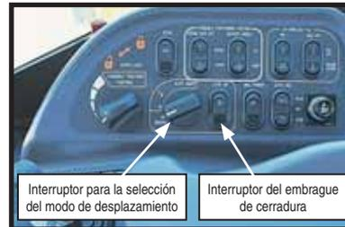
Este sistema controlado por el operario permite la selección de cambio manual o de cambio automático de dos niveles (bajo y alto). Con el modo Auto L (bajo) se obtiene un ahorro de combustible gracias a la sincronización del cambio de marchas establecida en velocidades más bajas que con el modo Auto H. Por tanto, el modo Auto L mantiene el motor en un margen de rpm relativamente bajo, con lo que ahorra combustible mientras proporciona fuerza de arranque cuando se toca el pedal acelerador.
